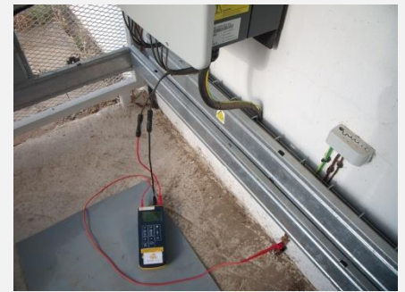
Recherche défauts d'isolement et traceur Courbes U-I
